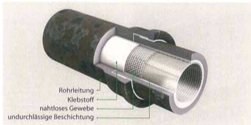
Abb. 2 Auskleidung der Rohrlinnenseite durch vollflächige und hinterwanderungs- dichte Verklebung mit einem nahtlos rundgewebten Geweschlauch aus hochfesten und alterungsbeständigen Fasern
